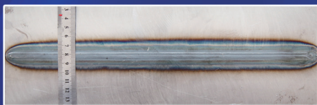
2mm碳钢焊缝正面成形
