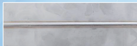
3mm不锈钢焊缝正面成形
