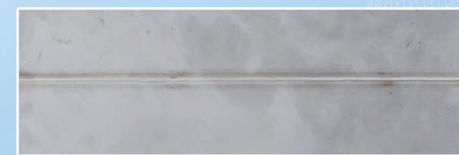
3mm不锈钢焊缝背面成形
