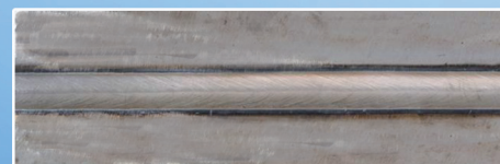
12mm不锈钢焊缝正面成形
