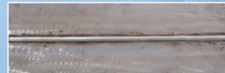
12mm不锈钢焊缝背面成形
